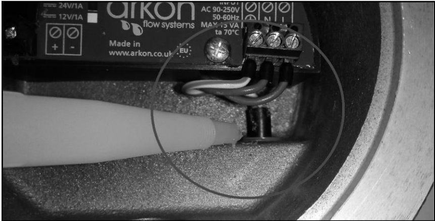
Imagen 1: Cable cruzado de corte redondo correctamente conectado dentro de la carcasa IP68 del MAGX2 Imagen 2: Aplicación de la silicona en la funda del extremo del cable cruzado de corte redondo
