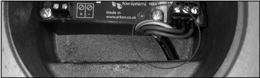
Imagen 1: Cable cruzado de corte redondo correctamente conectado dentro de la carcasa IP68 del MAGX2 Imagen 2: Aplicación de la silicona en la funda del extremo del cable cruzado de corte redondo
